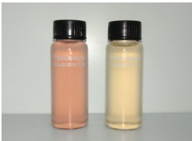
Figura 6. Cor de efluente antes do tratamento (à esquerda) e após o tratamento (à direita)
