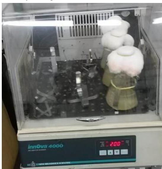
Figura 3. Condução dos processos fermentativos em frascos agitados.
