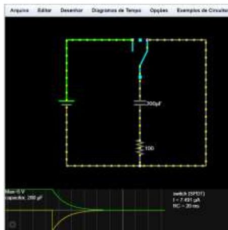
**Figura 9:** Simulação da descarga do capacitor. Nesta situação, a corrente flui no sentido horário apenas na malha da direita. Na parte inferior da figura tem-se os gráficos da tensão (curva decrescente) e corrente (curva crescente) em função do tempo. Fonte: os autores.
