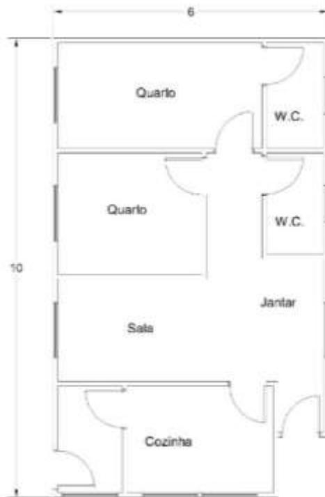
Figura 2 – Planta baixa de casa de 60m<sup>2</sup>. Fonte: própria.
