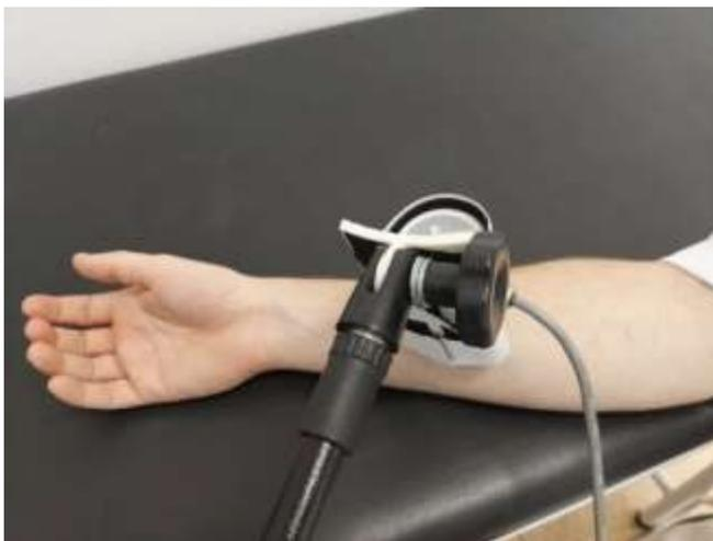
Figura 11: protótipo com o transdutor do Avatar sendo aplicado no corpo humano. Fonte: os autores.
