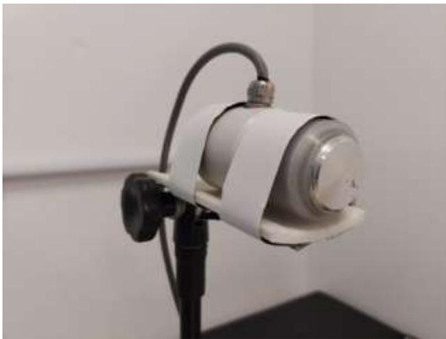
Figura 10: protótipo com o transdutor do Avatar. Fonte: os autores.
