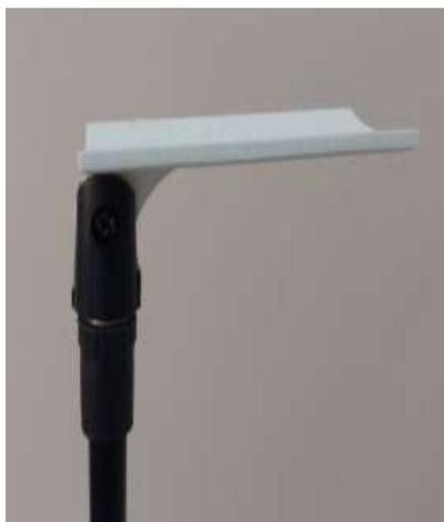
Figura 9: suporte para o transdutor do ultrassom acoplado em um pedestal. Fonte: os autores.
