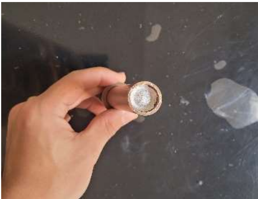
Figura 5: Motor compactado com uma parede de papel alumínio.
