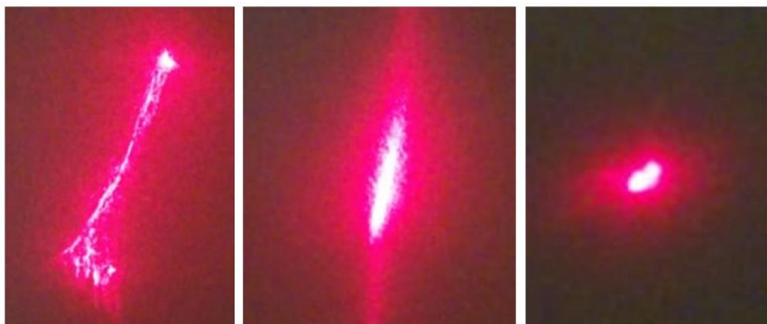
Figura 9 - (a) Imagem de como ficou difuso o reflexo da chapa de alumínio. (b) Imagem de como ficou difuso o reflexo da chapa de inox. (c) Imagem do reflexo do vidro de Silício, um único ponto sem muita difusão.
