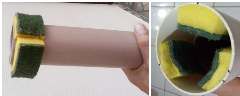
Figura 4 - Colagem da bucha cortada no cano e menor diâmetro; Colagem da bucha cortada no cano de maior diâmetro.
